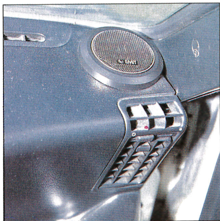
I tweeter EMIT, grazie al loro minimo spessore, hanno trovato una perfetta collocazione ai lati del cruscotto.
